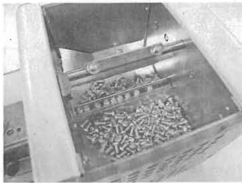
底板が上下してネジが中央のレールに並び、振動で左方向へ移動していく
